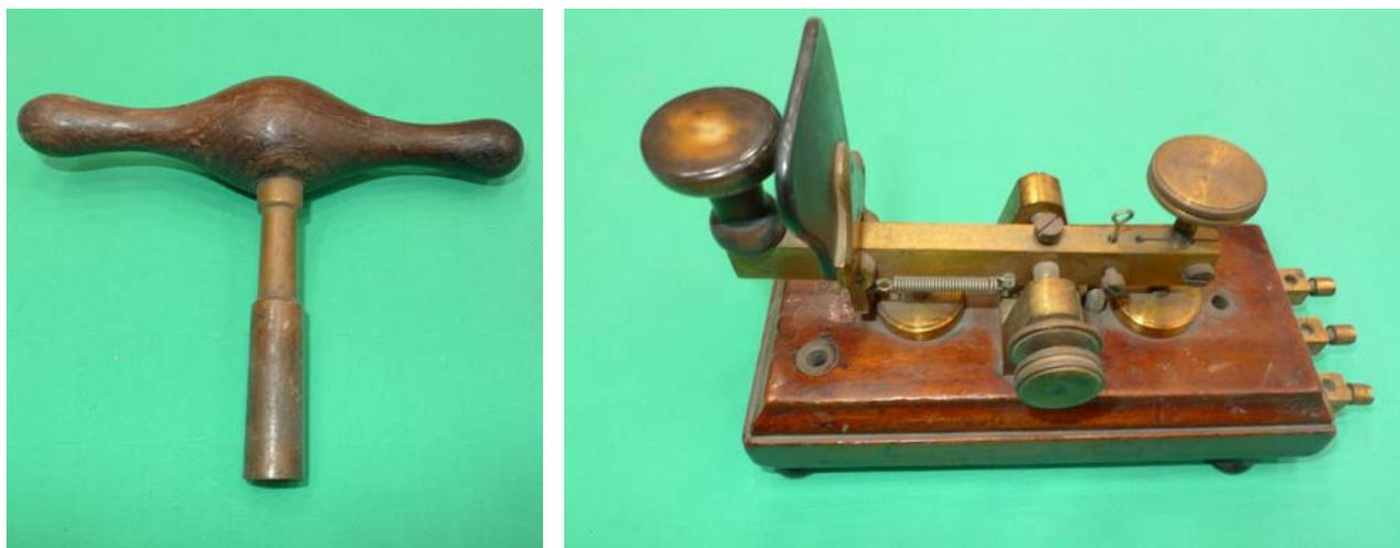
**Figura 23.** Chiave di carica del ricevitore e tasto trasmettente telegrafico, Pio Pion, Milano, 1906 – 1915.
