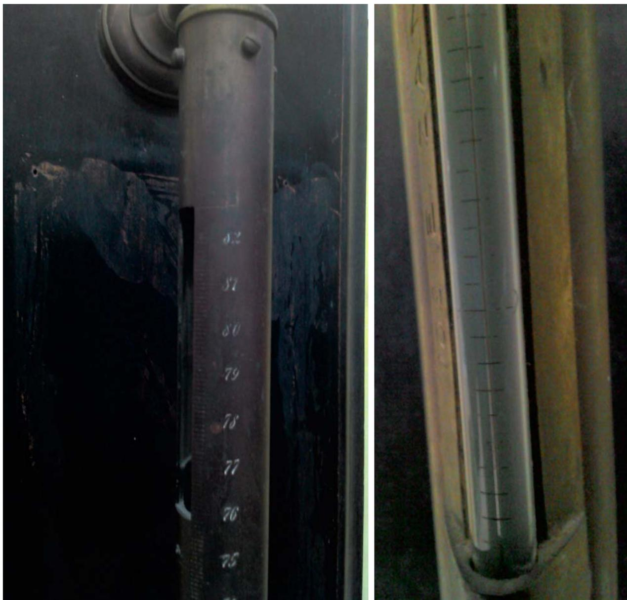
**Figura 14.** Particolare delle graduazioni: mercurio (sn) e termometro (dx), Barometro di Fortin, Zanchi, Roma, 1928.
