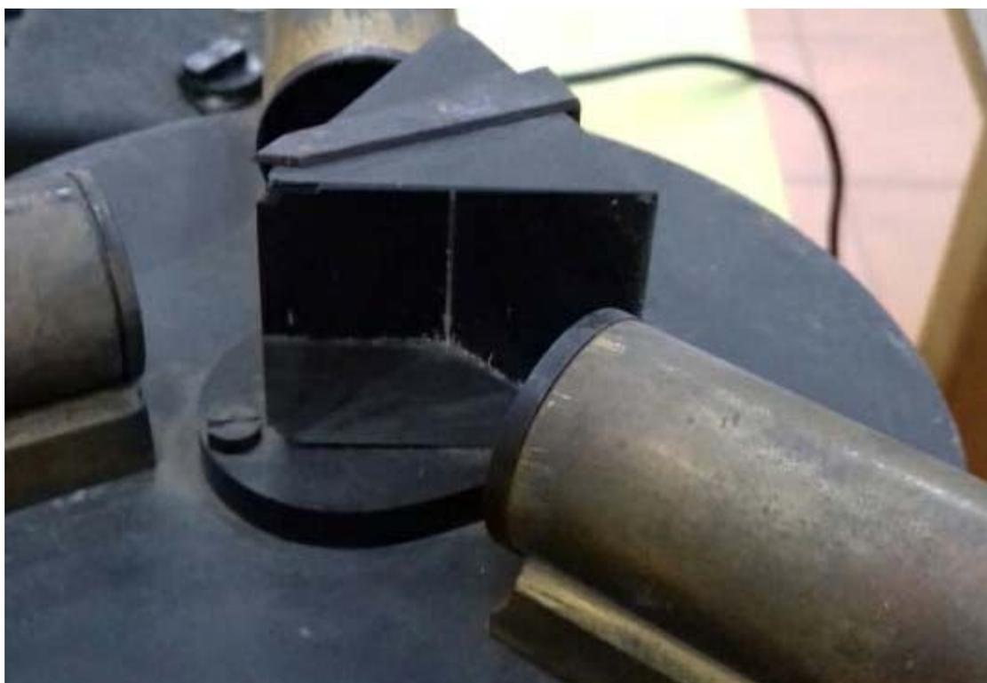
**Figura 17.** Particolare dello spettroscopio di Bunsen-Kirchhoff, 1880 – 1900 (foto Gina Sparano, che ringrazio).
