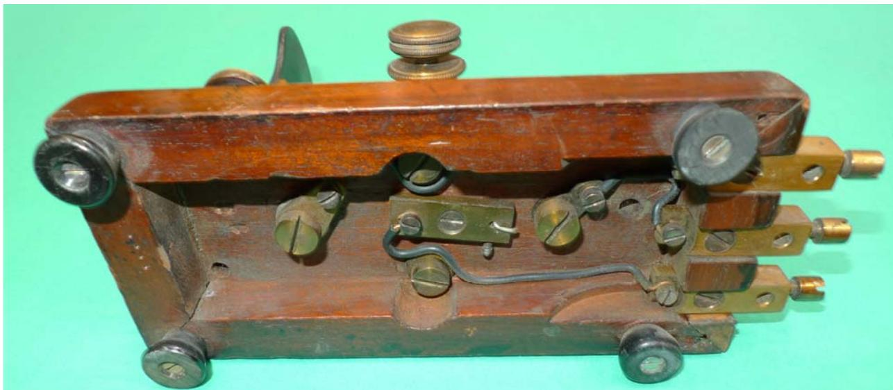
**Figura 24.** Particolare del tasto trasmettitore telegrafico, Pio Pion, Milano, 1906 – 1915.
