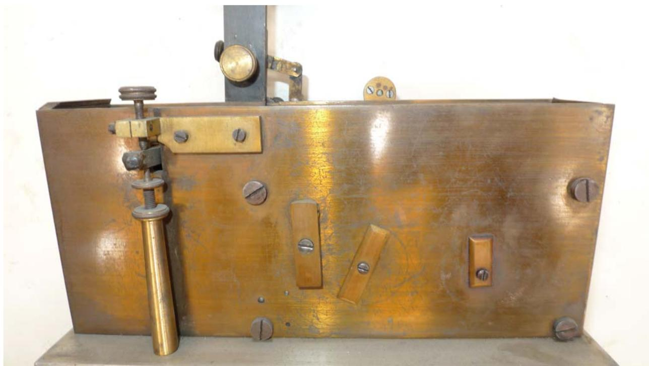
**Figura 19.** Veduta posteriore del ricevitore telegrafico, Pio Pion, Milano, 1906 – 1915.
