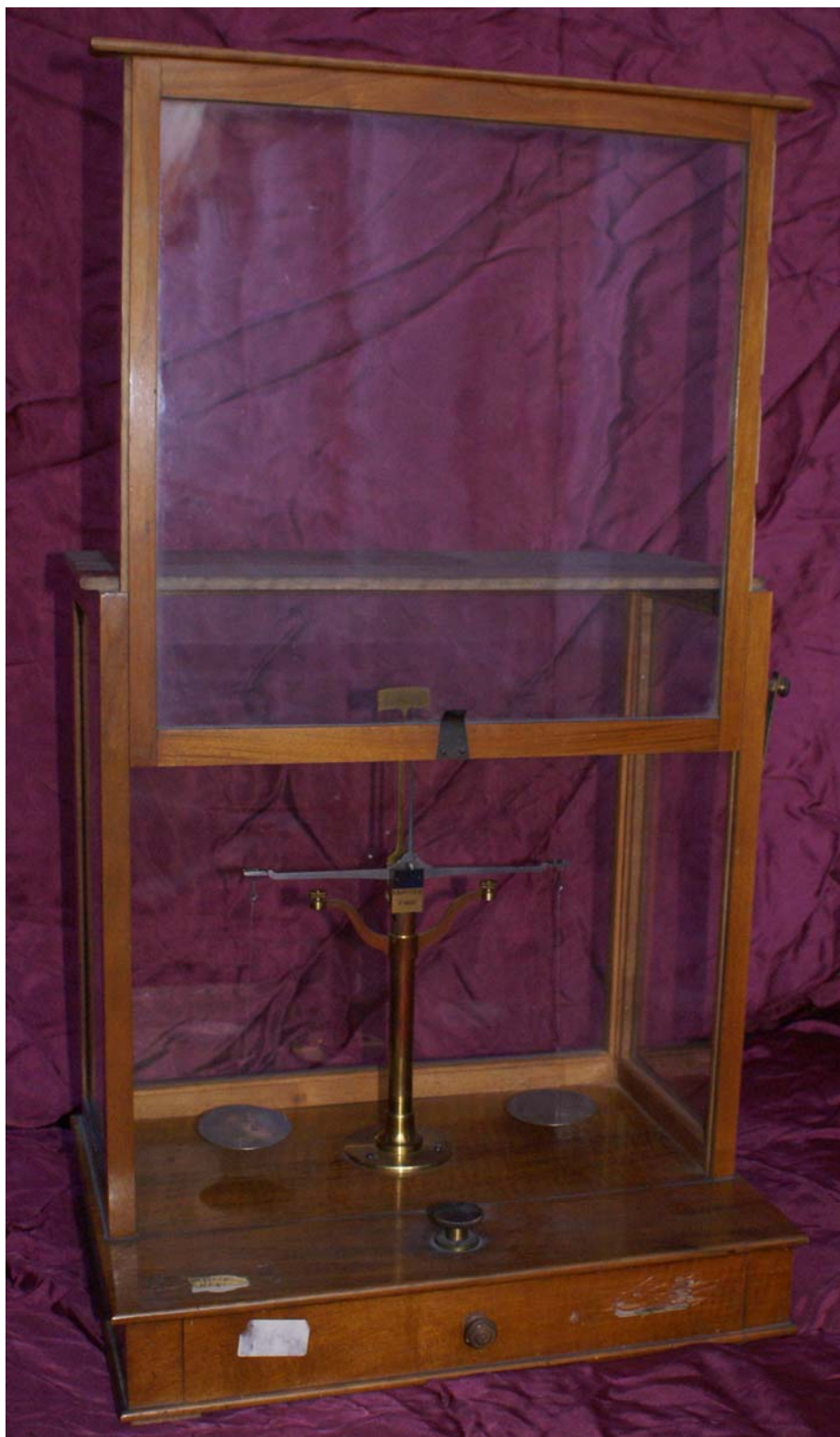
Figura 7. Bilancia analitica, Rousseau, Paris, 1870 – 1879.
