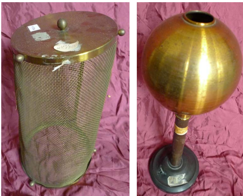
Figura 24. Gabbia di Faraday (a sinistra), 1880 – 1899; pozzo di Beccaria (a dex), 1871 - 1880.
