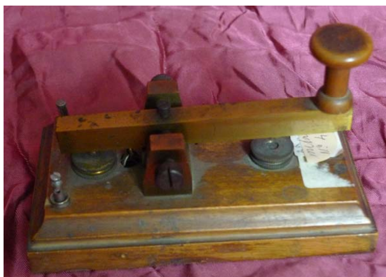
Figura 27. Telegrafo Morse trasmettitore, Tecnomasio, Milano, 1875 - 1880.
