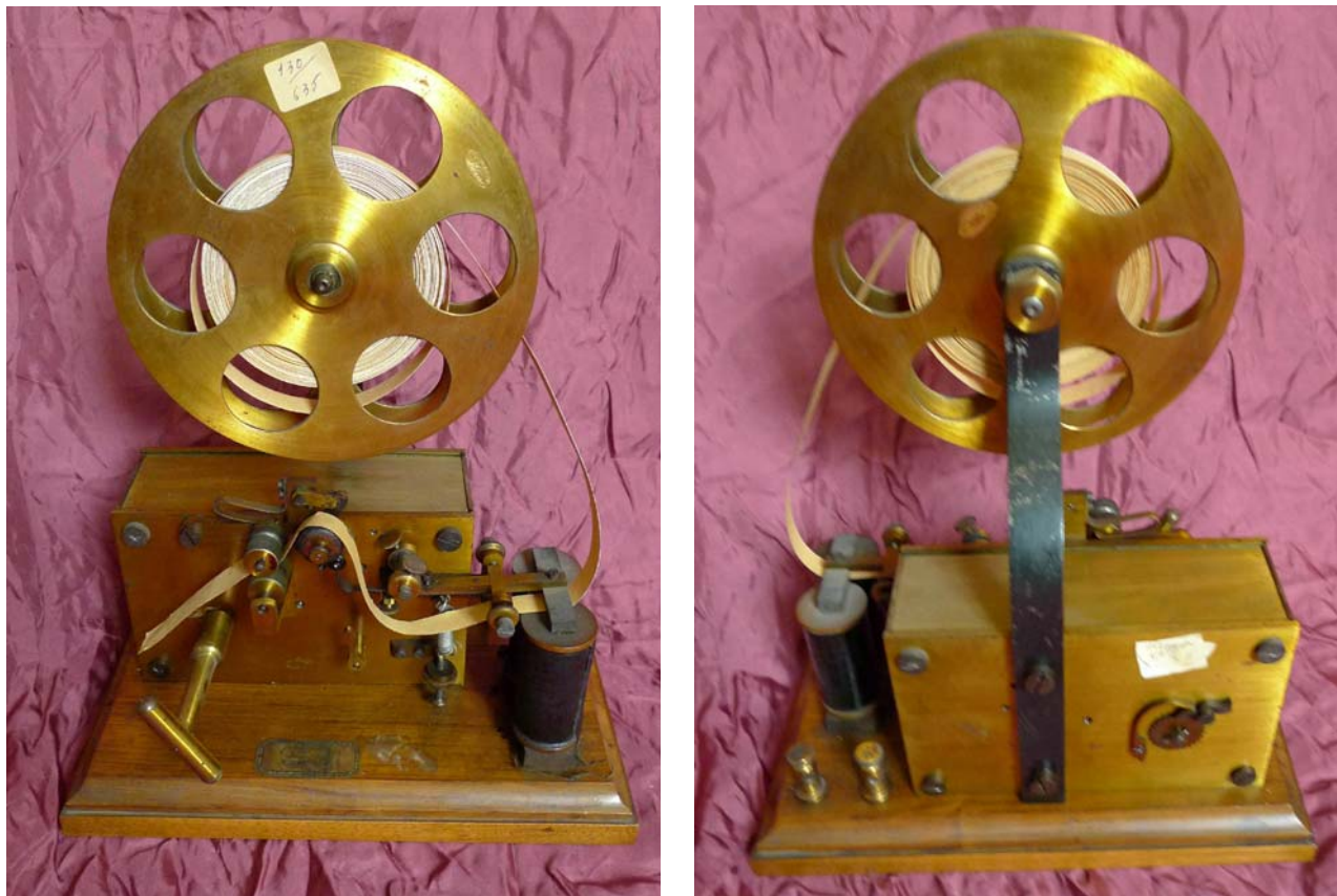
Figura 26. Telegrafo Morse ricevitore, veduta frontale e posteriore, Tecnomasio, Milano, 1875 - 1880.
