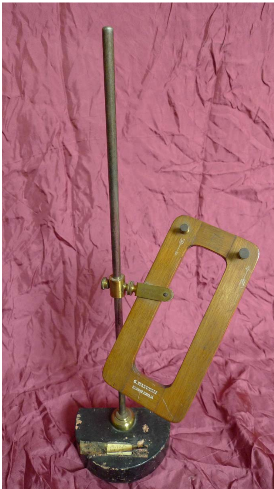
Figura 30. Moltiplicatore per legge di Ampere, 1881 - 1900.
