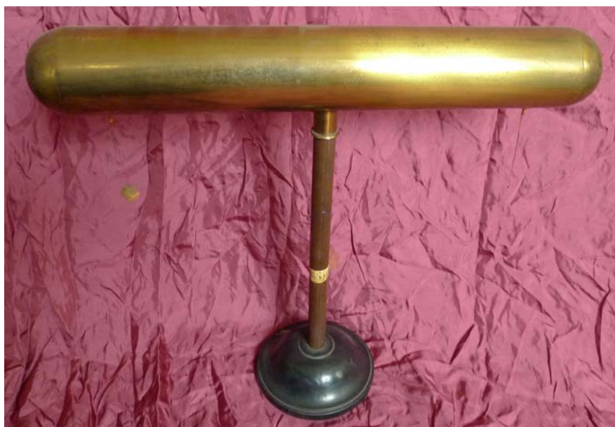
Figura 22. Conduttore metallico per pendolino elettrico, 1871 – 1880.
