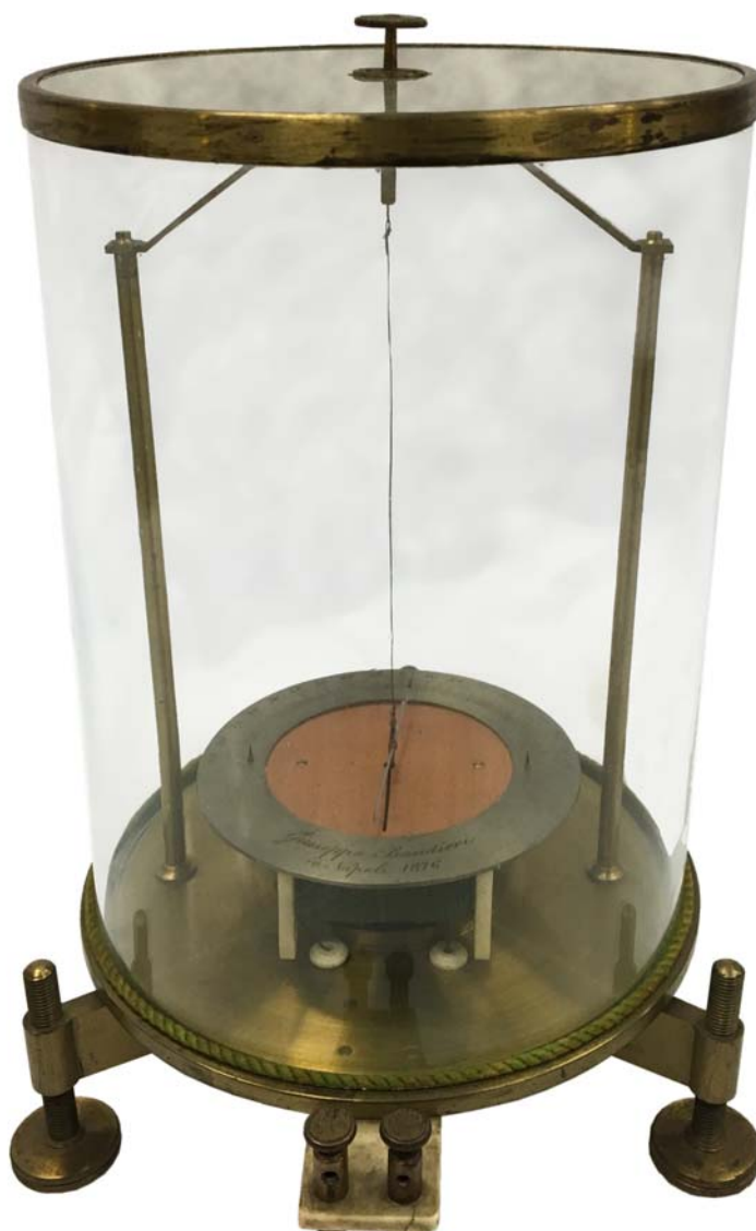
Figura 25. Galvanometro astatico di Nobili, Giuseppe Bandieri, Napoli 1876.
