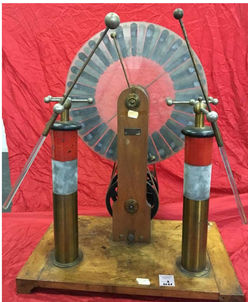
Figura 16. Macchina elettrostatica di Wimshurst, P. Potenza, Napoli, Milano, 1885 – 1915.
