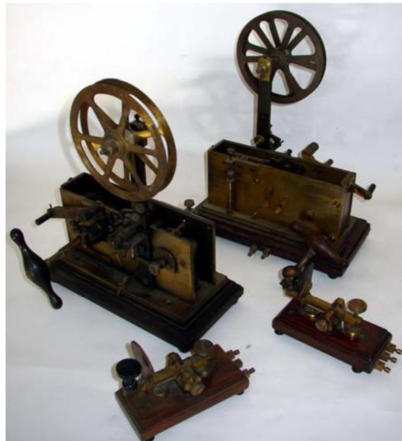
**Figura 13:** Coppia di ricevitori e trasmettitori per telegrafo Morse, Pio Pion Officine Milano, 1880-1890.
